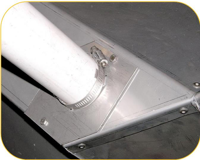
Distribution des suppléments et minéraux isolés, avec son système de vis flexible à l'intérieur de tuyaux de PVC blanc.
