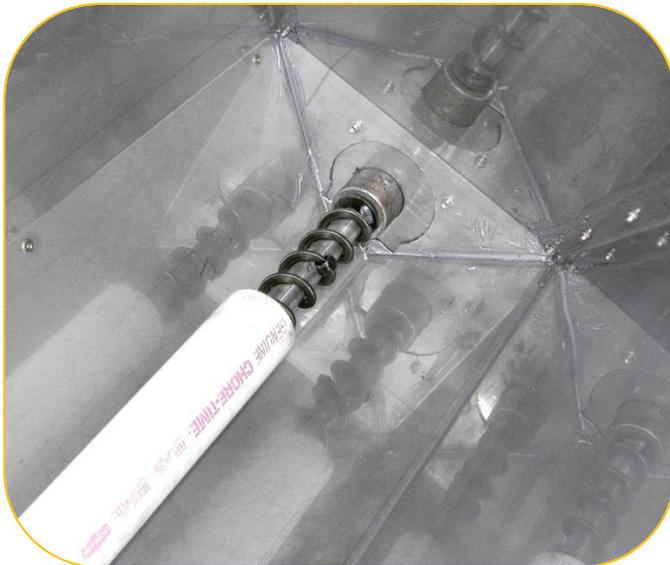
Vue intérieure d'un compartiment, avec vis flexible et tuyau en pvc.
